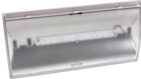
Luminaire à pictogramme de secours et de sécurité fin et convexe en plastique pour montage mural. Luminaire à pictogramme de secours avec set de pictogrammes intérieurs sans solvant à insérer, inclus dans la livraison standard. Il peut aussi être utilisé sans pictogramme comme luminaire de sécurité avec un écran translucide. Luminaire à pictogramme de secours / de sécurité selon DIN EN 60598-1, DIN EN 60598-2-22 et DIN EN 1838.
